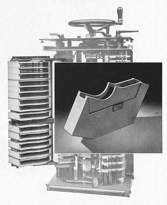
Funkenkammern aus Pyrostea für Schaltgeräte
