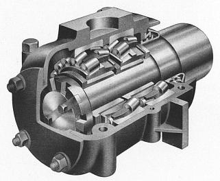
Achsbüchse mit Pendelrollenlagern
