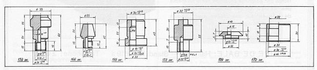
Fig. 3: Pièces acier usinées avec la même came revolver.
