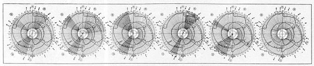
Fig. 4: Graphiques des cames pour les pièces de la fig. 3. Les hachures représentent les parties accélérées.
