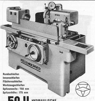
50 U HYDRAULISCHE UNIVERSAL-SCHLEIFMASCHINE
