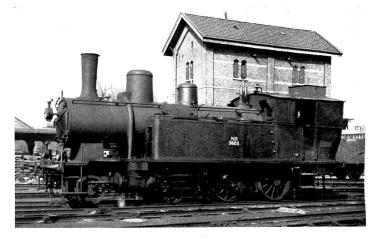
Eine der vielverwendeten schweizerischen Dampflokomotiven vom Typ Ec ¾, die heute in Holland verkehren, Bild vom Bahnhof Rotterdam,
