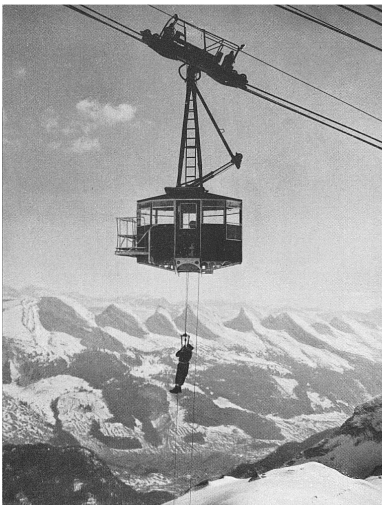
Abseilprobe. Tief in starken Bergungshosen hängend und erst noch festgebunden, gleitet ein Insasse einer Schwebebahnkabine langsam und ungefährdet zur sicheren Erde.* Exercice de sauvetage. Solidement attaché dans des caleçons de sauvetage, un passager de la cabine se laisse glisser à terre.
