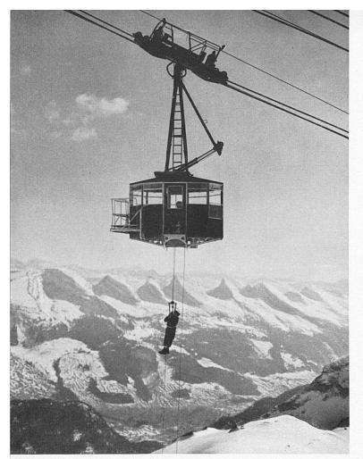
Abseilprobe. Tief in starken Bergungshosen hängend und erst noch festgebunden, gleitet ein Insasse einer Schwebebahnkabine langsam und ungefährdet zur sieheren Erde.\* Exercice de sauvetage. Solidement attaché dans des caleçons de sauvetage, un passager de la cabine se laisse glisser à terre.
