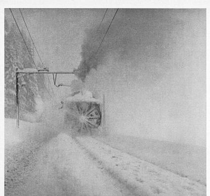
Chasse-neige à turbine en pleine action près de Wassen sur la ligne du Gothard. — Schleuder der Gotthardlinie in vollem Betrieb bei Wassen.
