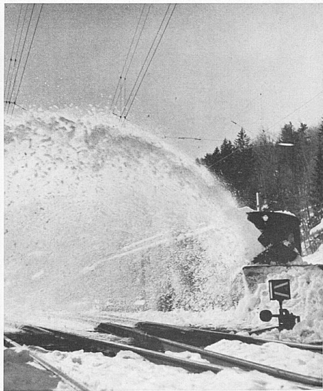
Machine électrique pour déblayer la neige sur la ligne du Brunig. — Elektrische Schneeschleuder der Brünig-Bahn.
