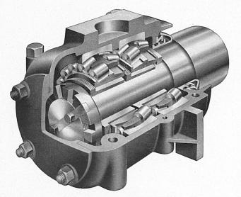
Achsbüchse mit Pendelrollenlagern
