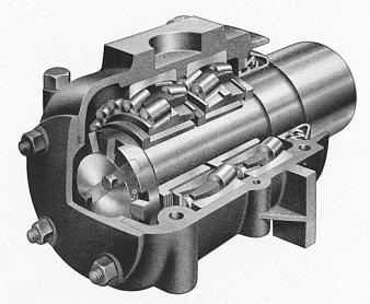
Achsbüchse mit Pendelrollenlagern
