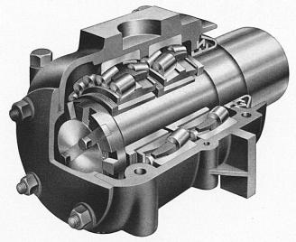
Achsbüchse mit Pendelrollenlagern
