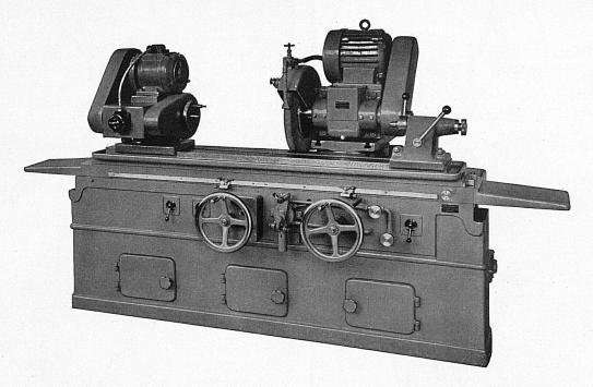
Construction de machines de précision à rectifier universelles, à rectifier planes, par commande hydraulique automatique et par commande à main
