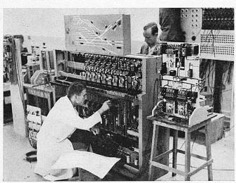
Moderne elektrische Stellwerkapparate werden sorgfältig geprüft, bevor sie das Versuchslabor verlassen.
