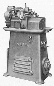
Automatische Abwälzfräser-Hinterdrehmaschine Nr. 124
