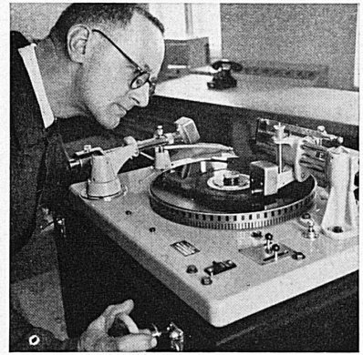
Enregistrement direct d'un disque pour reportage différé. Tonaufnahme einer Platte für eine spätere radio-phonische Wiedergabe.
