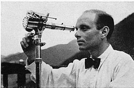
Actinomètre bimétallique pour les mensurations en série de l'intensité du rayonnement solaire, avec microscope de lecture et disque à écrans pour l'interposition d'écrans de verre coloré. Bimetallaktinometer für Serienmessungen der Sonnenstrahlungsintensität, mit Mikroskop-Ablesung und Filterscheibe zum Vorsetzen farbiger Glasfilter.
