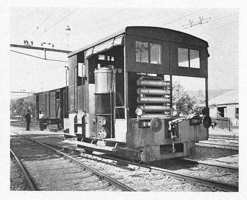
Einer der fünf SBB-Schienentraktoren mit IMBERT-Holzgasanlage
