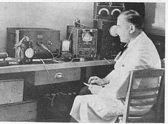
Voraussetzung für diese Methode ist unter anderm ein absolut exakt arbeitender Chronometer. Im Laboratorium wird er mittels einer sog. Zeitwaage (links) auf elektrischem Wege so exakt einreguliert, daß er in 24 Stunden höchstens eine Sekunde vor oder nach geht. Außerdem ist er in einen Thermostat eingebaut, so daß auch die Kälte im Freien als Fehlerquelle ausgeschaltet ist.
