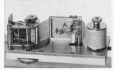
Der Schienenstoß-Meßapparat Syst. Neuweiler ist unentbehrlich zur Nachkontrolle von Stößen, geschweißten Stellen etc.
