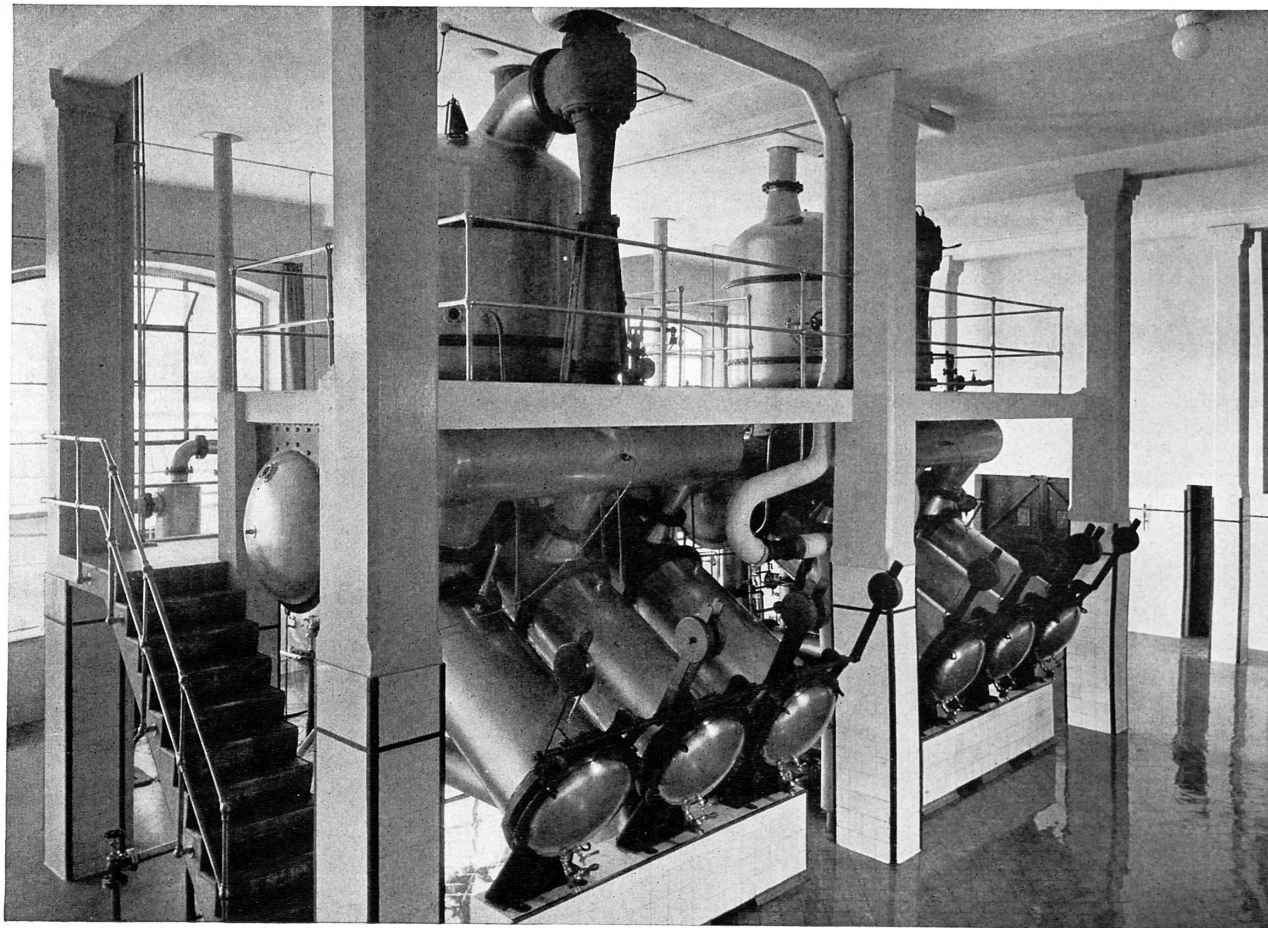
Kugelverdampfer einer Malzextraktionsanlage
