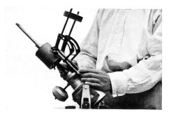
Sonnenscheinchronograph zur Registrierung der Dauer des Sonnenscheins durch Einbrennen auf Blaupapier mittelst einer der Sonne nachgeführten Linse
