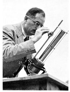
Amerikanisches Silberscheiben-Pyrheliometer für Präzisierung der Intensität der direkten Sonnenstrahlung
