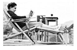
Davoser Frigorimeter zur Registrierung der klimatischen Abkühlungsgröße von Lufttemperatur, Wind und Strahlung, welcher der Patient bei der Liegekur ausgesetzt ist
