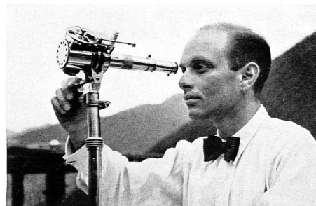
Bimetallaktinometer für Serienmessungen der Sonnenstrahlungsintensität, mit Mikroskop-Abmessung und Filterscheibe zum Vorsetzen farbiger Glasfilter
