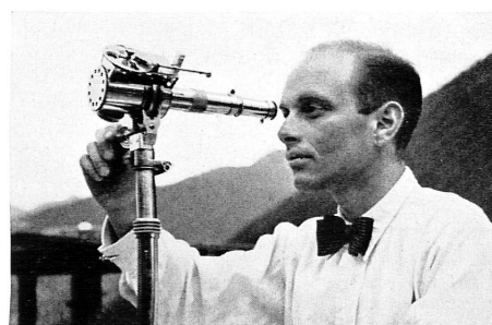
Bimetallaktinometer für Serienmessungen der Sonnenstrahlungsintensität, mit Mikroskop-Abmessung und Filterscheibe zum Vorsetzen farbiger Glasfilter
