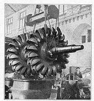
Rotor einer 15000-PS-Turbine Kraftwerk Amsteg der SBB.
