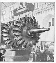
Rotor einer 15000-PS-Turbine Kraftwerk Amsteg der SBB.
