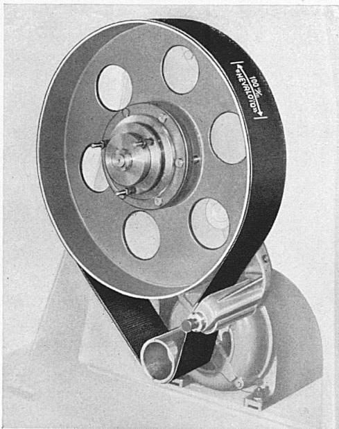
Antrieb einer Werkzeugmaschine durch endlos gewebten
