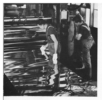
Links: Im Walzwerk Chippis der Aluminium-Industrie AG. Neuhauminium-Industrie ÄG. Neuhausen. Für schweizerische Aluminium-Legierungen, von der Weichheit des Silberpapiers bis zur Härte des Stahls, weitet sich der Abnehmerkreis zusehends. Die Elektrometallurgie ist eine der eindrucksvollsten Anwendungen der unerschöpflichen Elektroenergien unseres Landes.
