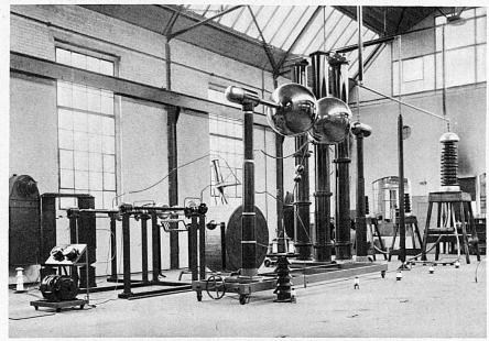
Stoss-Spannungsanlage für 1 Million Volt und 10000 Watt-sec. Leistung
