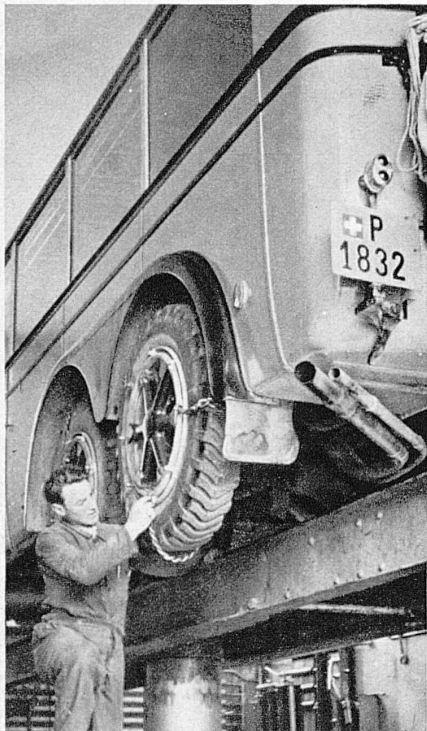
Die Einzelgliederkette wird in der Postgarage montiert und kontrolliert – La chaîne mince est placée sur la roue
