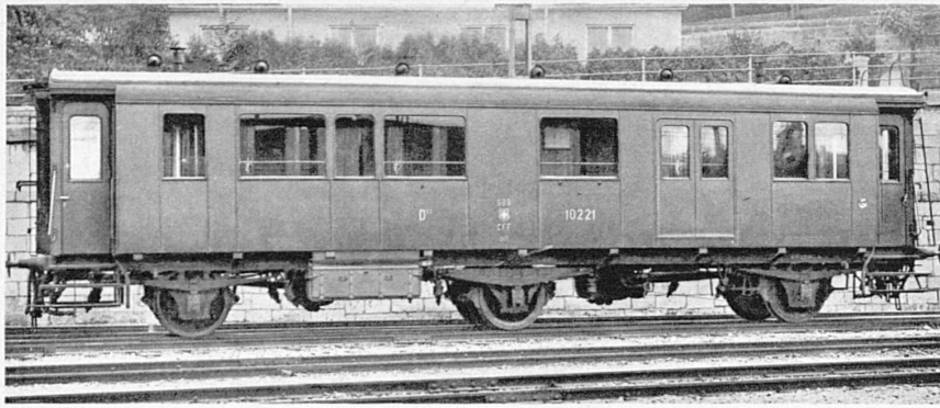
Ein dreiachsiger Krankenwagen der SBB – Wagon à trois axes des CFF destiné au transport des malades
