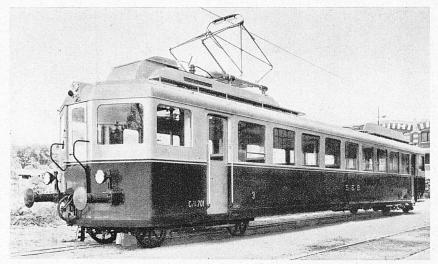
Automotrice monophasée Sécheron, destinée aux Chemins de fer des Alpes Bernoises. 3 automotrices livrées en 1935. Une deuxième commande importante vient d'être passée à Sécheron
