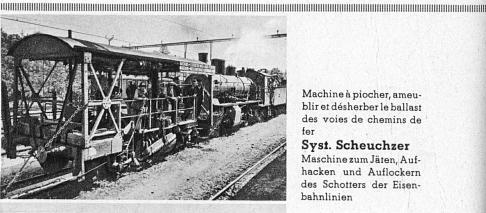
Machine à piocher, ameublir et désherber le ballast des voies de chemins de
