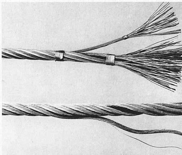
Oben: Drahtseil 15 mm Durchmesser, 222x0,7 mm, verzinkter Stahldraht mit 180–200 kg/mm<sup>2</sup> Bruchfestigkeit, nicht vorgeformt
