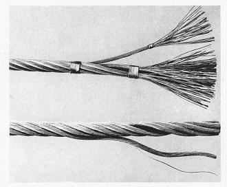
Oben: Drahfseil 15 mm Durchmesser, 222 × 0.7 mm, verzinkter Stahldraht mit 180-200 kg/mm1 Bruchfestigkeit, nicht vorge-
