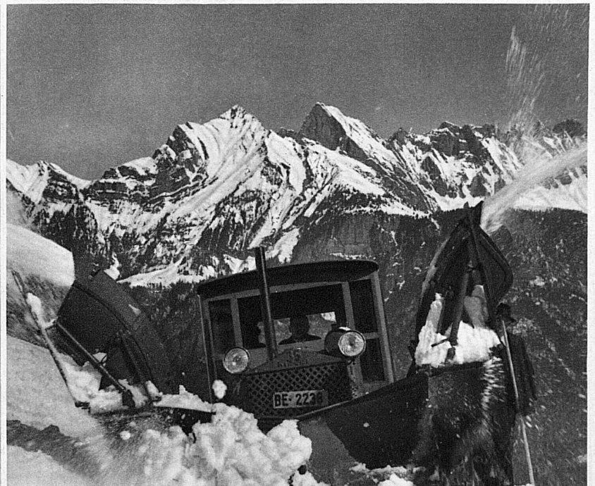
Cletrac-Schneesleudermaschine an der Arbeit auf der Flumserbergstrasse – Le chasse-neige Cletrac en action sur la route de Flums
