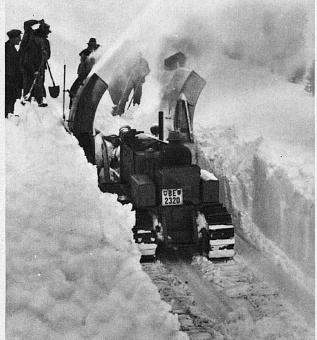
Der Schnee kann durch die drehbaren Kanäle nach derselben Seite geworfen werden – Utilité des canaux tournants
