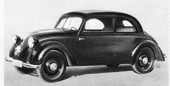
Der neue Mercedes-Benz-Heckmotorwagen Typ 170 H, 9 Steuer-PS. Vollschwingachse, Schnellganggetriebe. — La nouvelle Mercédès-Benz à moteur disposé à l'arrière. Type 170 H. 9 ch.-impôts, toutes les roues à suspension indépendante. Relais démultiplicateur.
