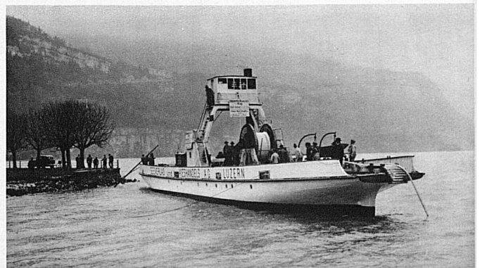
Ankunft des Verlegungsschiffes in Brunnen nach Auslegung des Kabels
