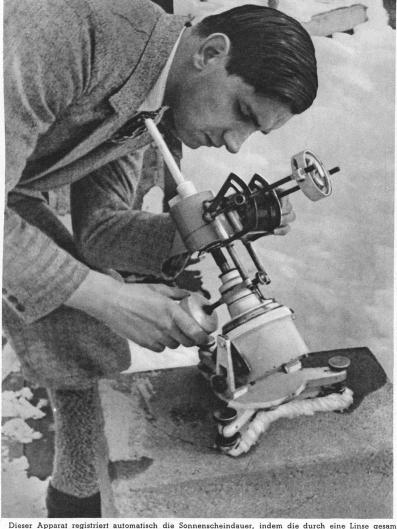
Dieser Apparat registriert automatisch die Sonnenscheindauer, indem die durch eine Linse gesammelten Sonnenstrahlen eine Brennspur auf eine Walze schreiben – Cet appareil enregistre automatiquement l'insolation du fait que les rayons solaires, concentrés dans une lentille, sont enregistrés par une trace carbonée sur un tambour
