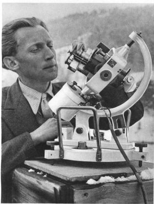
In diesem automatisch der Sonne nachgeführten Pyrheliographen fallen die Sonnenstrahlen auf eine geschwärzte Thermosäule. Dadurch wird ein elektrischer Strom erzeugt, der ein Mass für die Gesamtintensität der Sonnenstrahlung gibt – Cet appareil Pyrheliographe automatique enregistre les rayons solaires sur un « thermosäule ». De ce fait, un courant électrique est produit qui donne l'intensité totale de l'insolation
