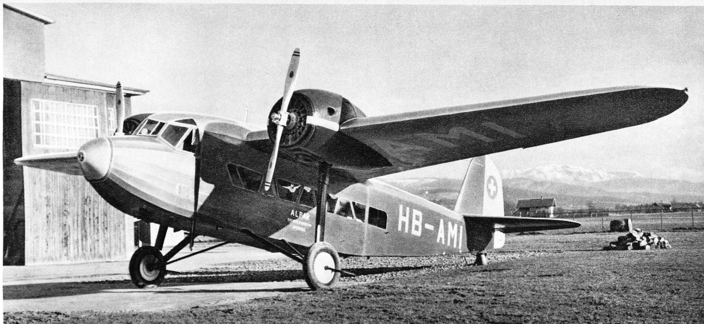
Das neue zweimotorige Verkehrsflugzeug Typ Koolhoven F. K. 50 der Alpar-Bern bietet dank der Anordnung der Tragflächen den Passagieren eine völlig freie Sicht nach unten – Nouveau modèle d'avion Typ Koolhoven F. K. 50, grâce à la position de ses ailes, les voyageurs jouissent du panorama au-dessus duquel ils survolent
