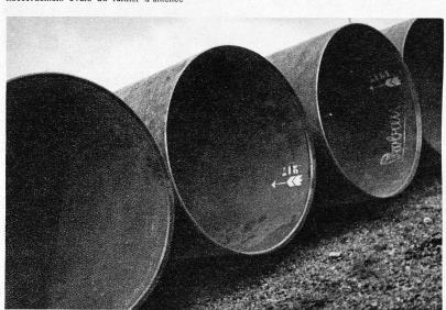
Die mächtigen, 19 Tonnen schweren Druckleitungsrohre (Gebr. Sulzer AG., Winterthur), für deren Montage eine Seilbahn gebaut wurde – Les puissants tuyaux de 19 tonnes de la conduite forcée (Fabr. Sulzer S. A., Winterthour), pour le montage desquels il a fallu créer un funiculaire spécial
