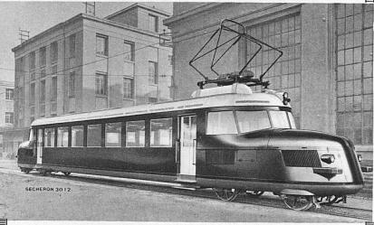
Automotrice électrique rapide pour les CFF: Appareillage Electrique de la S.A. des Ateliers de Sécheron.
