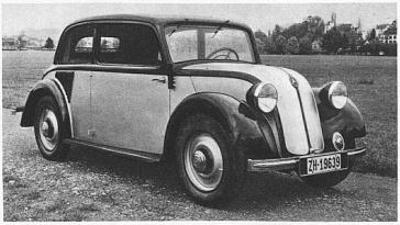
« Mercédès-Benz », Type 130, 4 cyl., 7 CV, avec moteur à l'arrière « Mercedes-Benz », Typ 130 mit Heckmotor 4 Zyl., 7 PS
