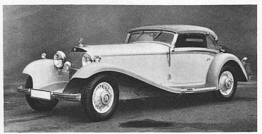
« Mercédès-Benz », Type 500, à compresseur, 26 CV, 8 cyl. « Mercedes-Benz », Typ 500, Kompressor, 26 PS, 8 Zyl.
