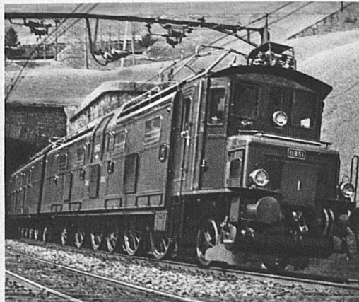
Eine der neuen grossen elektrischen Gotthardlokomotiven, die mit 8500 PS gewaltige Züge über die steilen Gottthardrampen hinaufführt
