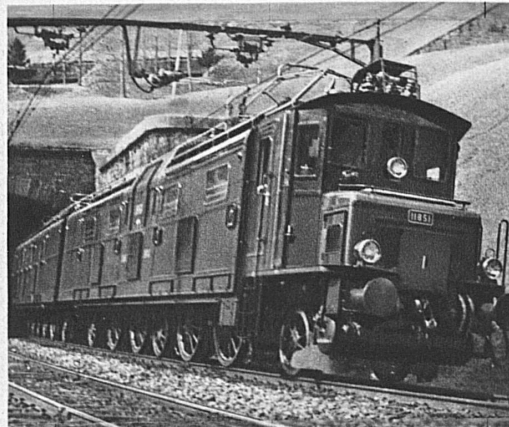
Eine der neuen grossen elektrischen Gotthardlokomotiven, die mit 8500 PS gewaltige Züge über die steilen Gotthardrampen hinaufführt
