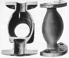
Dampf-Ventil aus **P. M. G. - Metall,** das einen Druck bis zur Zerstörung von 380 kg/cm² ausgehalten hat. Kupfer 88 °/<sub>n</sub>, Härtner 10 °/<sub>o</sub>, Zink 2 °/<sub>o</sub>, Wandstärke am Bruch 4 mm
