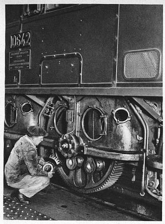
Was in der Radverschalung ist: das Zahnrad, das die Motorkraft auf die Laufachse überträgt. Aber aufpassen: der Motor ist abgefedert und das Rad nicht, so dass sich Verschiebungen ergeben und die Zähne nicht greifen würden? Erfinden Sie rasch die notwendige Lösung, und sagen Sie dann dem Arbeiter, wie er sein Stück einsetzen muss! Vielleicht sind Sie ein technisches Genie?
