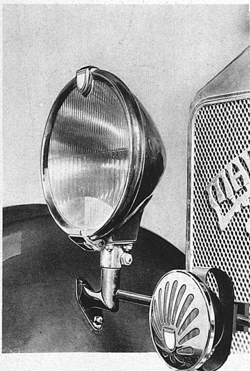
Scheinwerfer, Muschelhorn und vollständige Zünd-, Licht- und Anlasseranlage der Scintilla AG. in Solothurn
