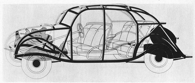
Chassisrahmen und tragende Teile der Karosserie beim Chrysler «8» sind zu einem einheitlichen Stahlkörper verschweisst
