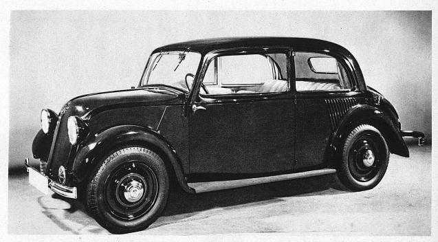
Mercedes-Benz Vollschwingachslimousine Typ 130 mit Heckmotor 7 PS., der Schrittmacher für den Wagen der Zukunft
