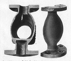
Dampf-Ventil aus P.M.G.-Metall, das einen Druck bis zur Zerstörung von 380 kg/cm² ausgehalten hat. Kupfer 88%. Härtner 10%, Zink 2%, Wandstärke am Bruch 4 mm
