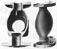
Dampf-Ventil aus P.M.G.-Metall, das einen Druck bis zur Zerstörung von 380 kg/cm² ausgehalten hat. Kupfer 88 % Härtner 10%, Zink 2%, Wandstärke am Bruch 4 m
