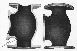
Ventilgehäuse aus **P.M.G. Bronze** mit 5 mm Wandstärke das bei einer Druckprobe 335 kg/cm² Wasserdruck bis zum Bruch ausgehalten hat
