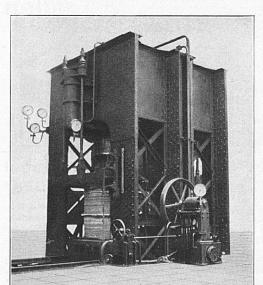
Hydraulische Plattenpresse für 4500 t Betriebsdruck m. Presspumpe Aktiengesellschaft der Maschinenfabrik von
