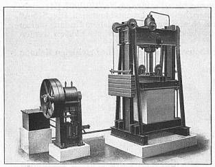
Hydraulische Packpresse mit Pumpe
