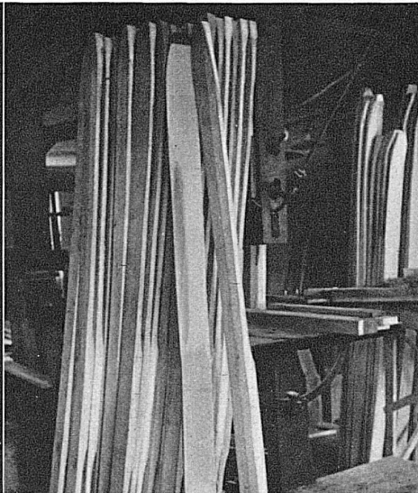
Maschinell zur ersten Verarbeitungs-Rohform behandelt, aber noch keinerlei Biegung aufweisende Skilatten
