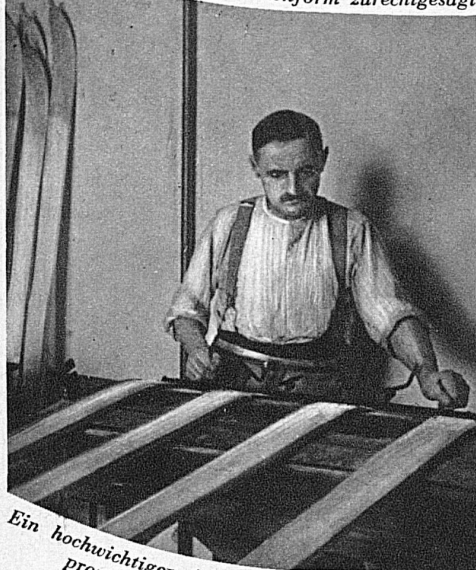
Grosses Lager schon in Amerika zugeschnittener Skilatten. Das Eschen-Skiholz wird erst beim Skifabrikanten vor der Lagerung auf die Rohform zurechtgesägt
