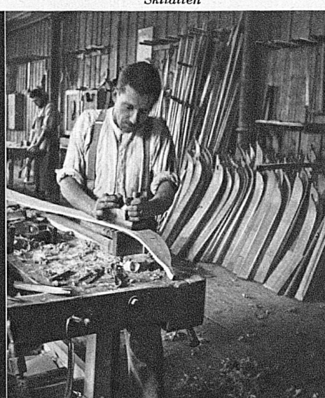
Feingefühl erfordert das Verputzen der Lauffläche
