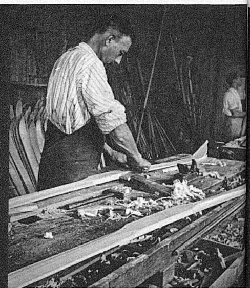
Noch heikler ist die endgültige handarbeitliche Formgebung und Ausbalancierung der Skioberfläche
