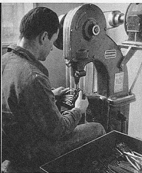
Pro Minute einhundert Seitenriemen nietet diese Maschine
