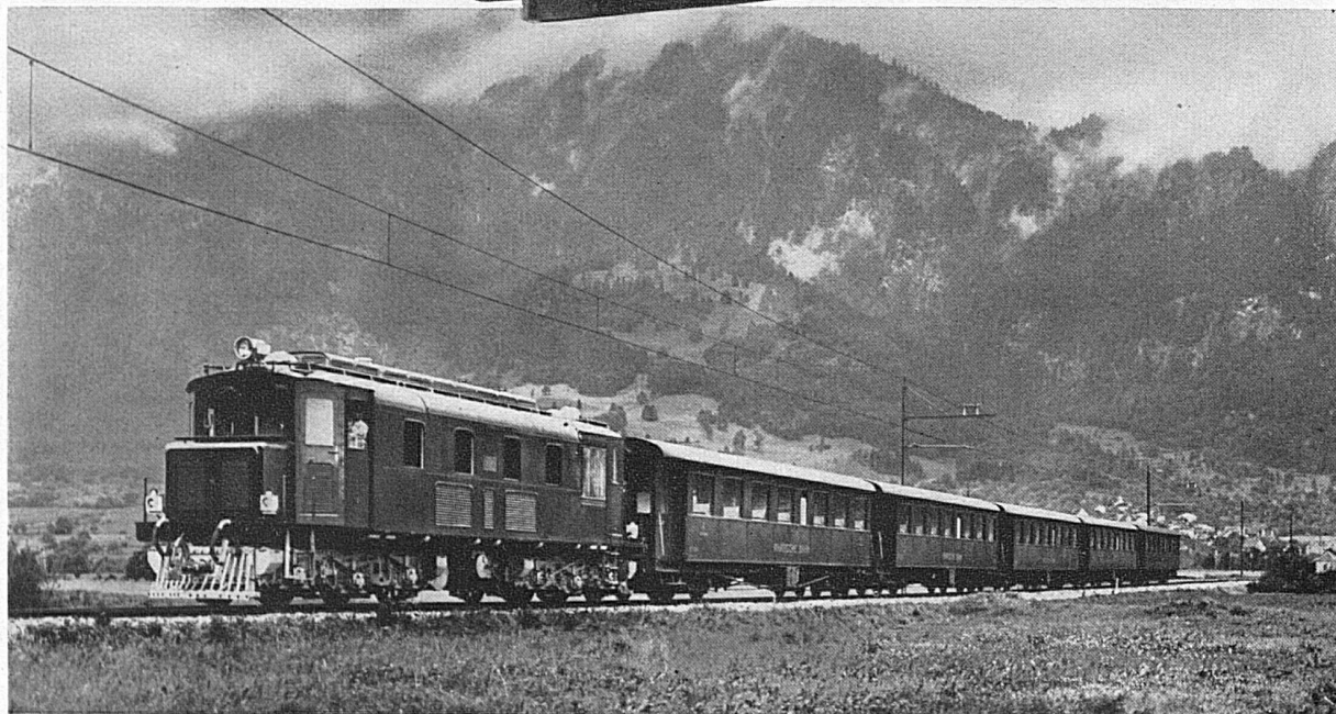
Die erste von sechs für die Siamesischen Staatsbahnen gelieferten 450 PSe Sulzer-Diesel-Lokomotiven Versuchsfahrt auf dem Netz der Rhätischen Bahnen
