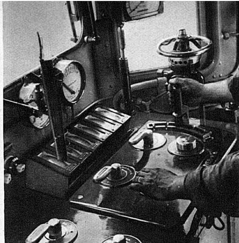
In der Hand des Führers liegen 8500 PS gebändigt! Alle Messinstrumente, Hebel und Apparate sind auf dem Führertisch der elektrischen Lokomotive übersichtlich angeordnet
